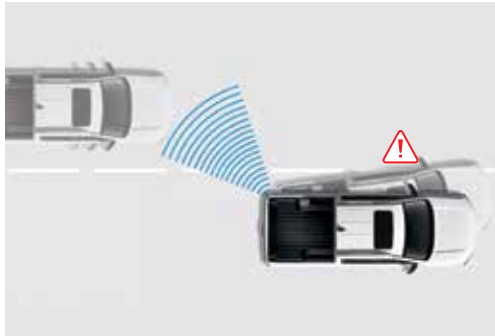
부주의 운전 경고 DAW (Driver Attention Warning) 주행 패턴과 전방 카메라에 수집된 정보를 분석, 운전자가 부주의하다고 판단 시 주의운전 레벨을 단계별 안내해주는 시스템입니다.
