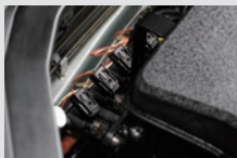
LPG 인젝터 엔진 인젝터에 LPG를 분사하는 장치
